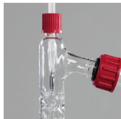
Doc. 8 Lors d'une distillation fractionnée, on mesure la température d'ébullition du distillat, ce qui prouve sa nature.
